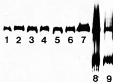
Abb. 1. Platten-Disk-Elektrophorese nach Maurer [5], Gelsystem Nr. 1, Trennstrecke 10 cm. Aufgetragen wurden verschiedene Fraktionen der Phenylsepharosesäule (bis zu 130 µg Protein). Die Fraktionen 8 und 9 entstammen einem zweiten Aktivitäts- und Protein-peak, der stets noch ein zweites inaktives Protein enthält.
